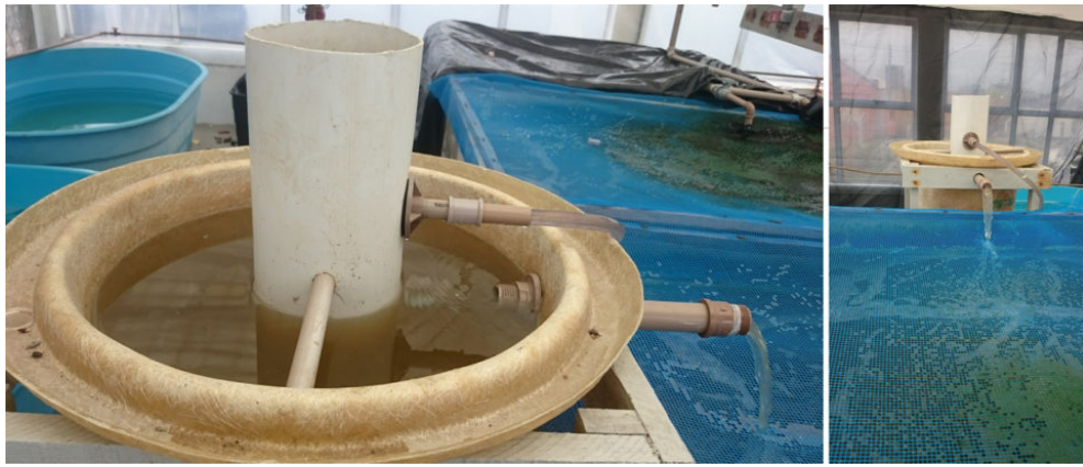
Vista del sistema de eliminación de sólidos en la configuración experimental.
