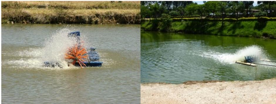
El encendido de aireadores de paleta durante las horas pico de la fotosíntesis causa la pérdida de oxígeno de las aguas superficiales sobresaturadas de OD. Sin embargo, los aireadores de paleta son eficaces para mezclar el agua del estanque y promover el aumento de oxígeno en las aguas profundas. Fotos de Fernando Kubitza.
