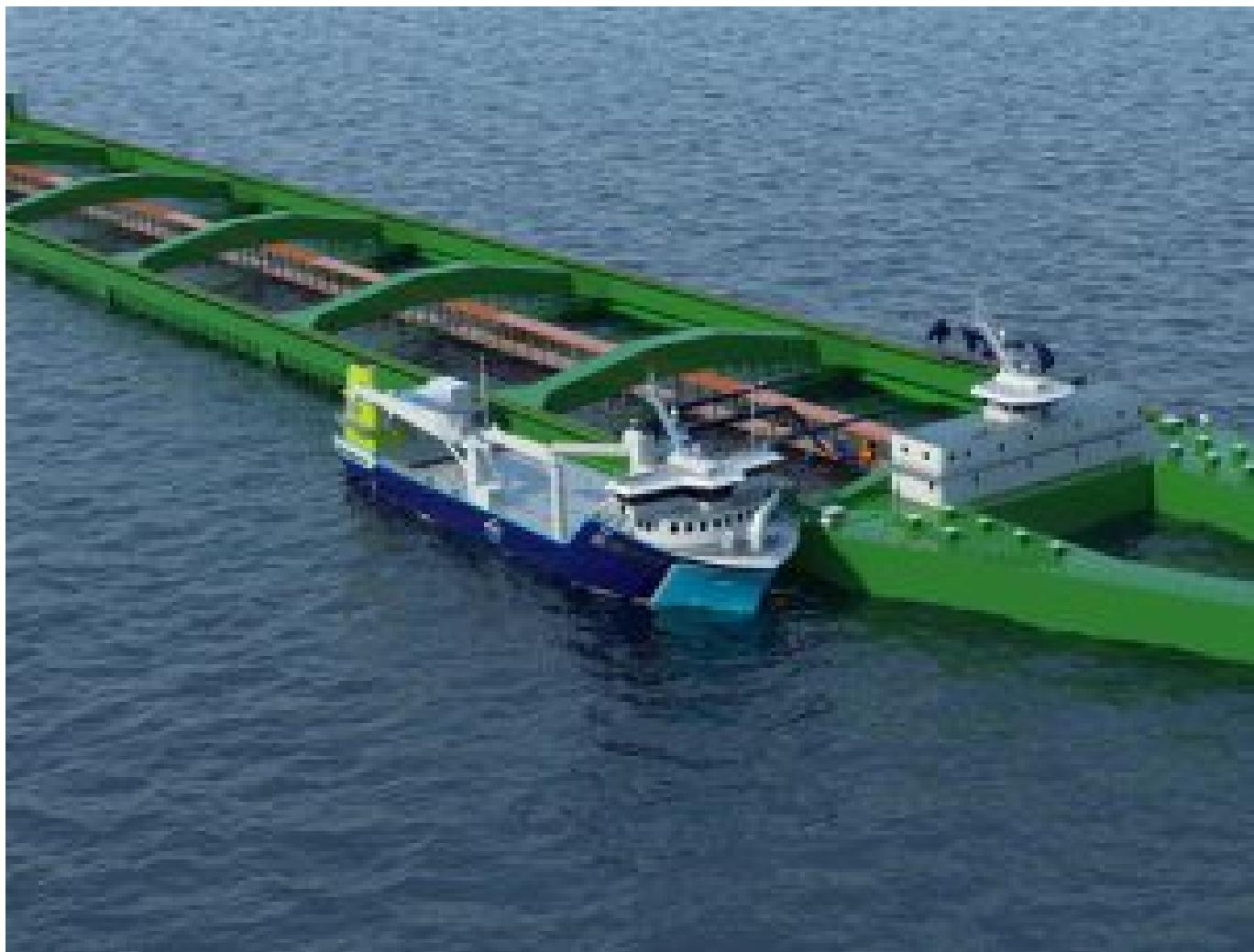
El prototipo de piscifactoría en alta mar de Nordlaks es una instalación gigante en forma de barco, una desviación importante de los diseños tradicionales de piscifactorías.
