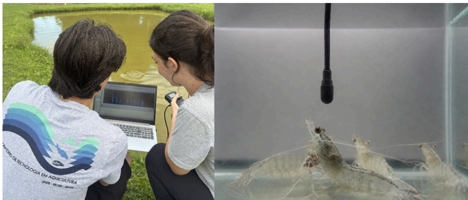
Fig. 2: Ejemplos de despliegues de PAM en un estanque experimental de camarones y en un acuario, utilizando grabadoras digitales e hidrófonos sumergidos.
