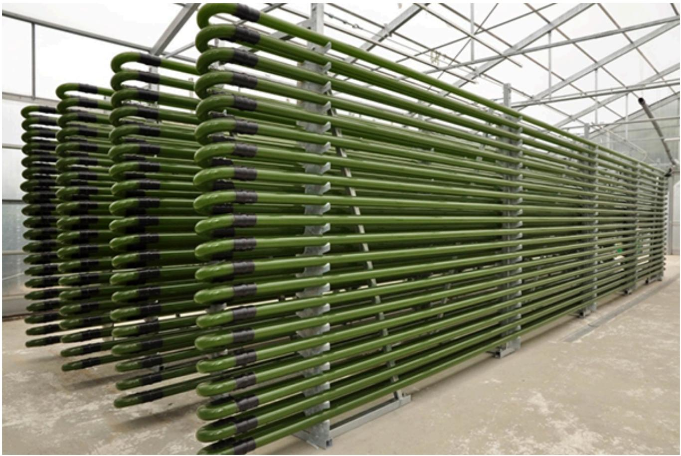
Fotografía de IGV Biotech (CC BY-SA 3.0, <https://creativecommons.org/licenses/by-sa/3.0/>, vía Wikimedia Commons) que muestra un fotobiorreactor tubular de vidrio para el cultivo de microalgas y otros organismos fotosintéticos. Este tipo de fotobiorreactor es adecuado para la producción a gran escala de productos de alto valor a partir de microalgas.
